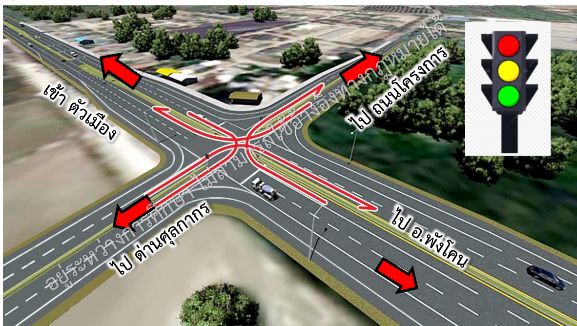
รูปที่ 6-6 รูปแบบทางแยกบริเวณจุดตัดทางหลวงหมายเลข 222 (จุดเริ่มต้นโครงการ) สี่แยกระดับพื้น
