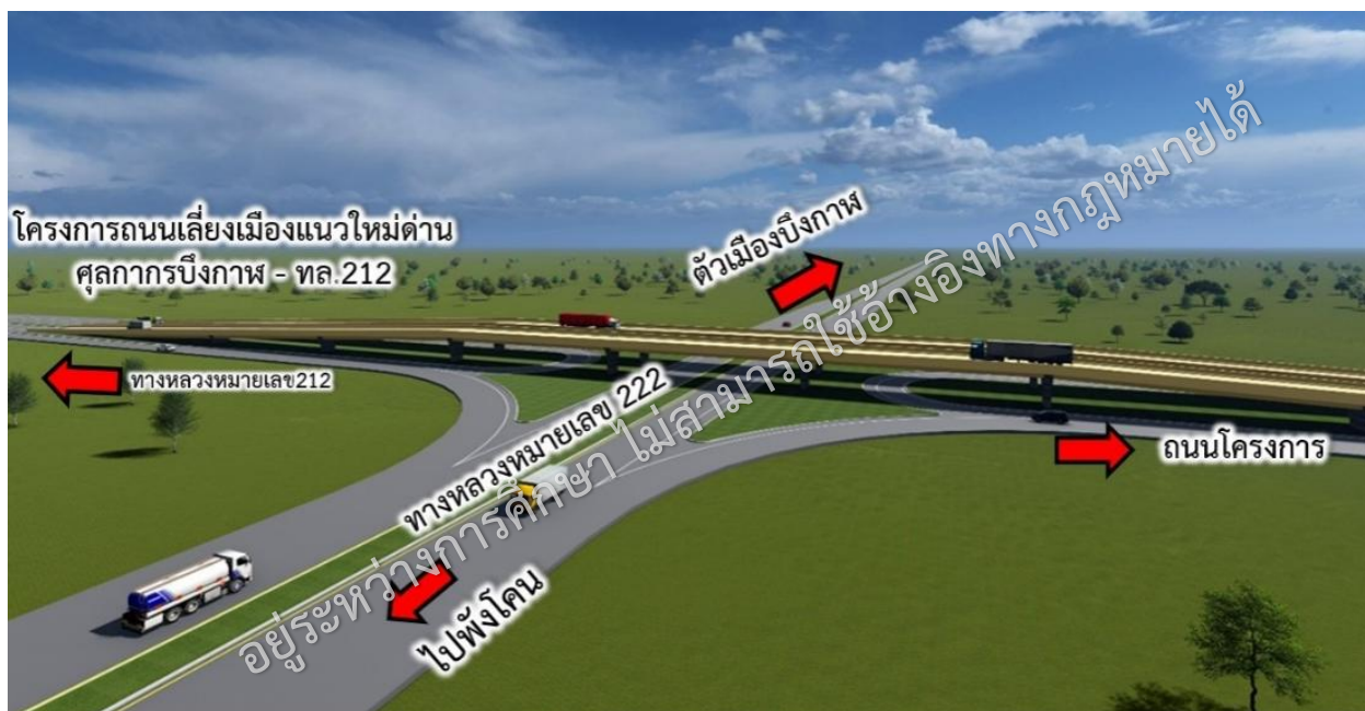
รูปที่ 6-7 รูปแบบทางแยกบริเวณจุดตัดทางหลวงหมายเลข 222 (จุดเริ่มต้นโครงการ) รูปแบบสะพานข้ามทางแยก
